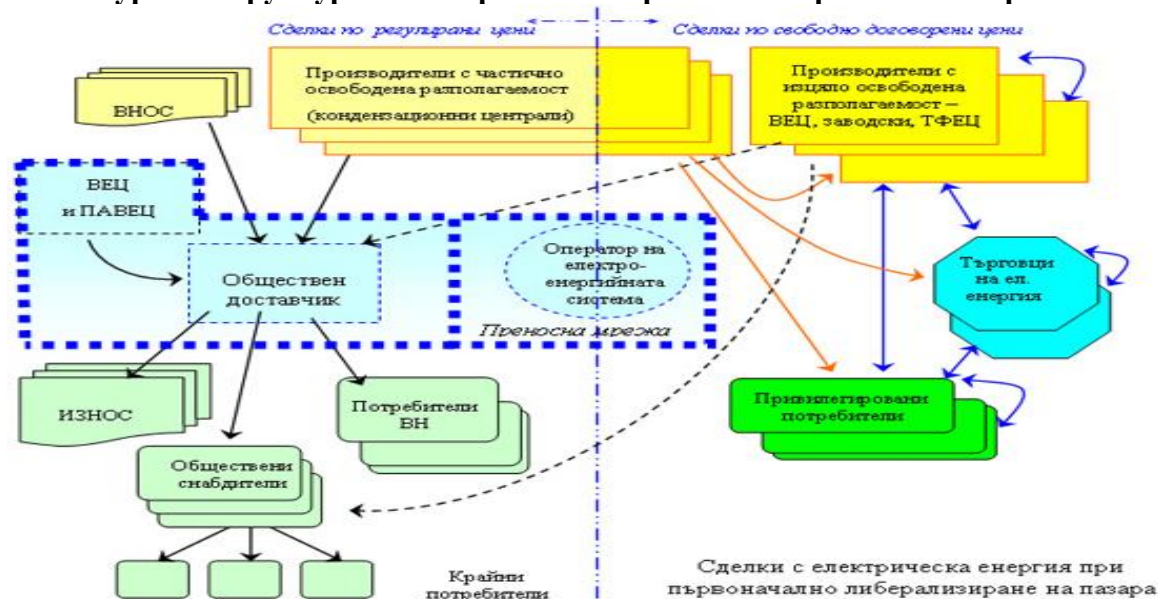
Фигура 2: Структура на пазара на електрическа енергия в България
